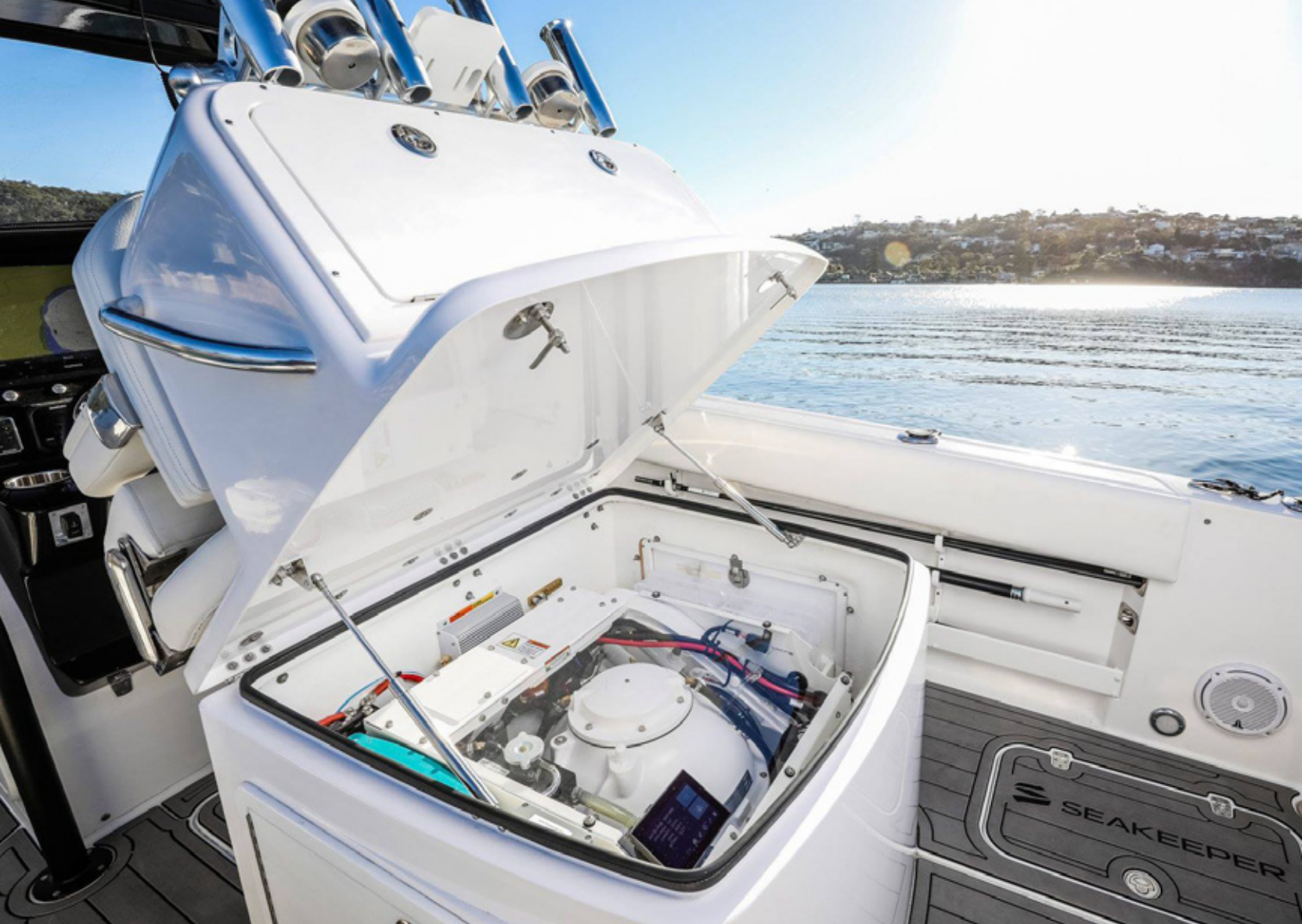
STABILT: Her er en Seakeeper 3 stabilisator montert i en Contender 32, en amerikansk fritidsfiskebåt. Foto: Seakeeper.
